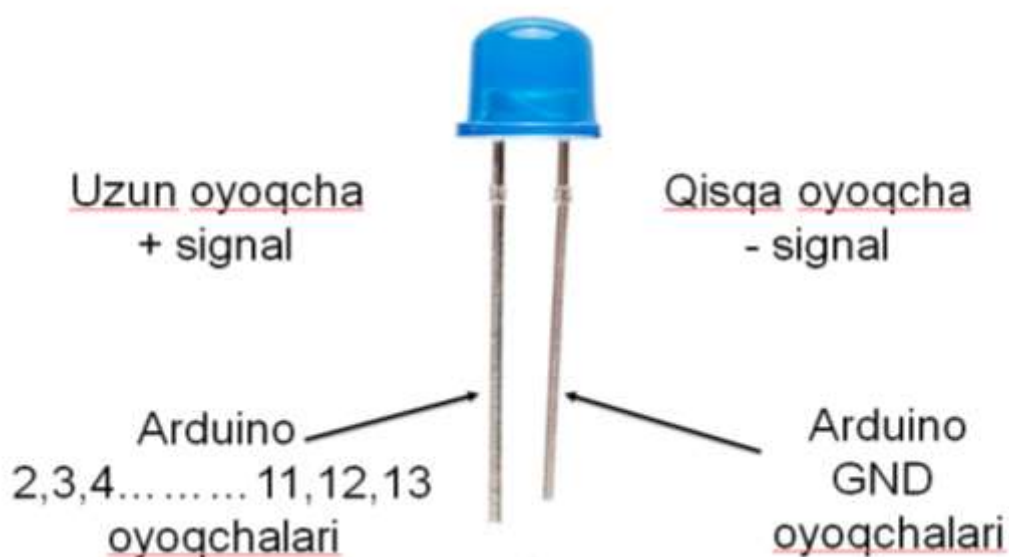
3-rasm. Svitadiodning tuzilishi
