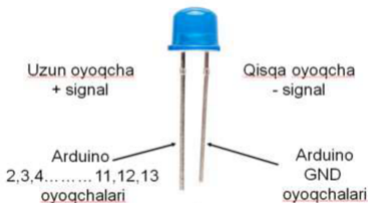
4-rasm. Svetodiodning uzun va kalta oyoqchalari
